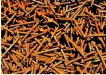
شكل (٣-١١): المسامير يعلوها الصدأ إثر تعرضها للرطوبة.
